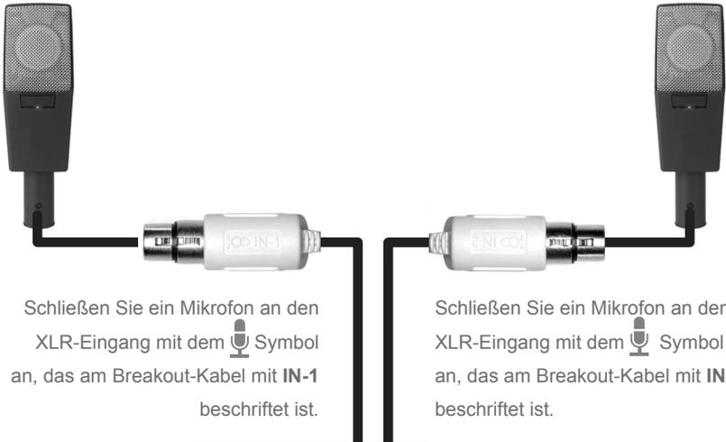
Schließen Sie ein Mikrofon an den XLR-Eingang mit dem
