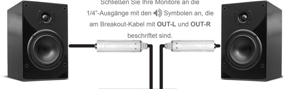
Falls Ihre Lautsprecher oder Stereoeingänge mit Cinch-Steckern versehen sind, verwenden Sie bitte die mitgelieferten Adapter. Schließen Sie zunächst den Adapter an die **OUT-L** und **OUT-R**-Anschlüsse des Duet-Breakout-Kabels und dann das Cinch-Kabel an.
